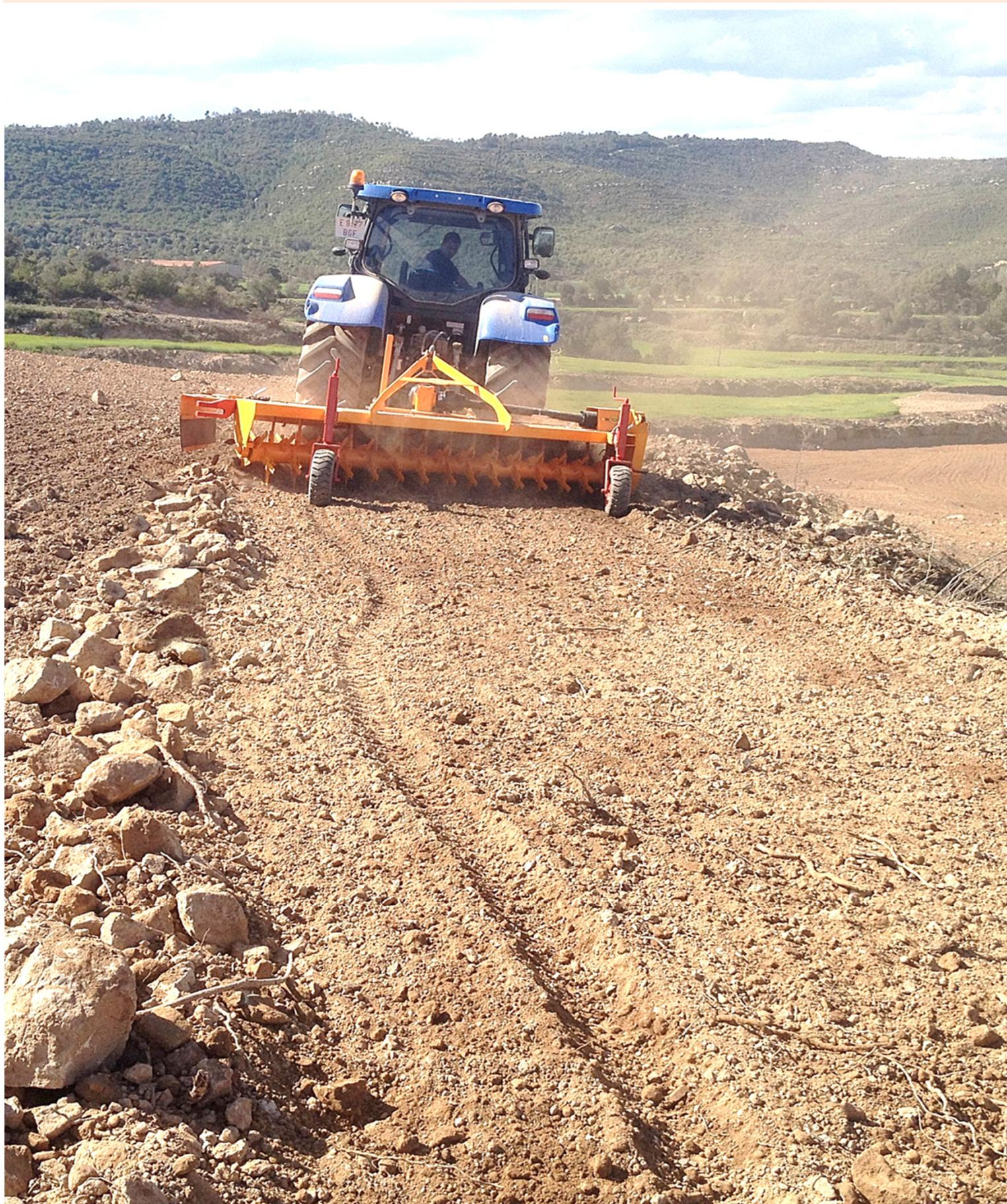
Este **Rastrillo** hilera todas las piedras superficiales de hasta **300 mm.** de diámetro facilitando así la posterior recogida por cualquier máquina.
