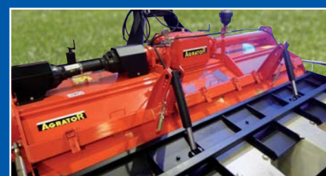
Sistema de regulación de presión Système de regulation de pression Hydraulic pressure system
