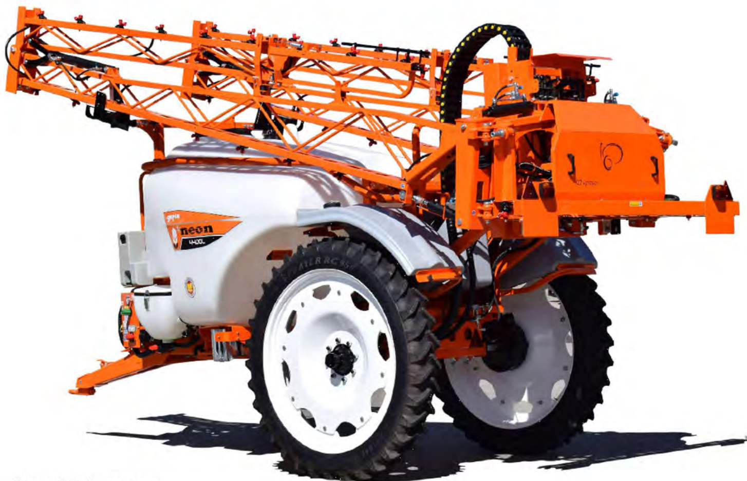
iNeon 4000 lts con barra q7 de 21 mts
