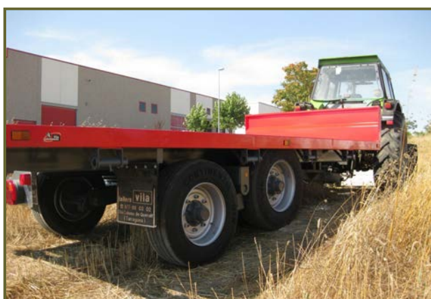
Plataforma fixa de 5'80 mts. Plataforma fija de 5'80 mts.
