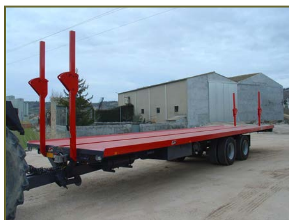
Plataforma fixa de 10'30 mts. per 18 tn. Plataforma fija de 10'30 mts. para 18 tn.
