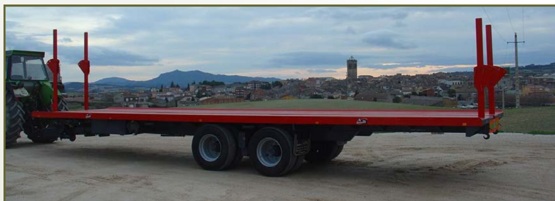
Plataforma fixa de 10'30 mts. per 18 tn. Plataforma fija de 10'30 mts. para 18 tn.
