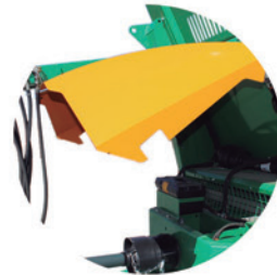
ALOJAMIENTO PARA REGULADOR ELÉCTRICO Y SUSPENSIÓN HIDRÁULICA / PLACE FOR ELECTRICAL REGULATOR AND HYDRAULIC SUSPENSION
