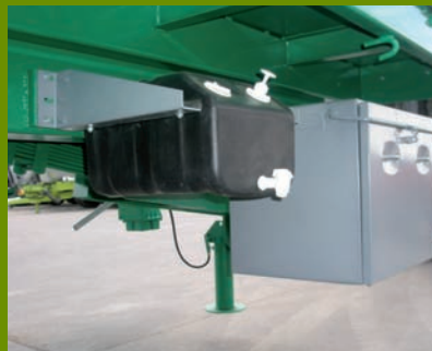
Deposito y cajón de herramientas Water tank and tool box
