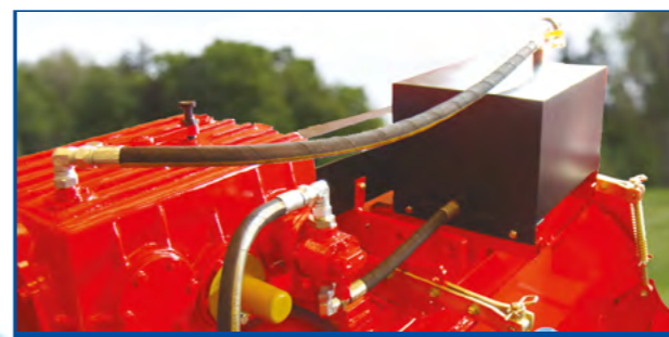
Sistema de refrigeración del aceite de la caja de cambios Système refroidissement d'huile boîte de vitesses Oil cooling system on central gearbox
