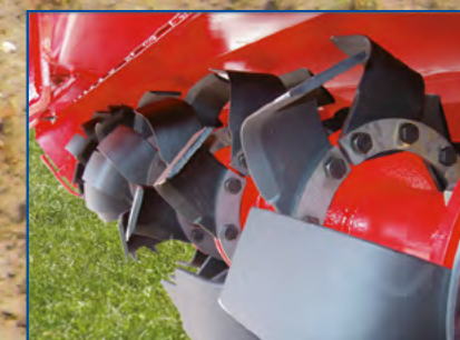
Opción doble plato (modelo forestal) Option double flasque (modèle forestier) Double flange (extra heavy duty model)
