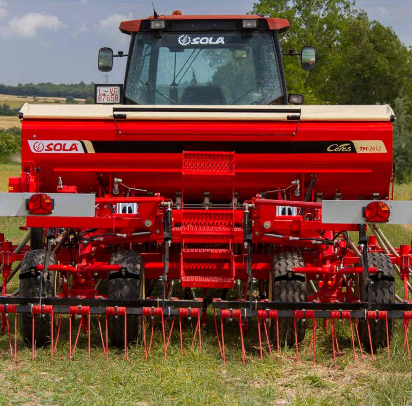
Sistema telescópico de plegado de equipo de siembra. De 3 m en posición de transporte a 4 m en posición de trabajo.
