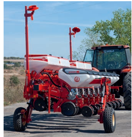
Con transporte de punta el ancho es de 3m. / Con telaio fisso e trasporto longitudinale con larghezza di trasporto di 3m.
