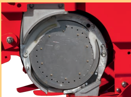
Juego de discos de siembra a elegir. Un kit di dischi di semina a scelta.
