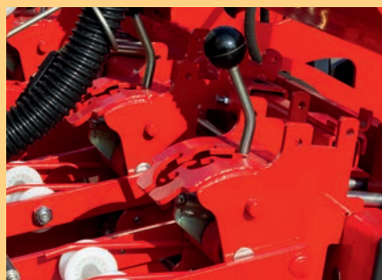
Regulación de presión del elemento. Regolazione della pressione dell'elemento con cinque posizioni (80Kg max).
