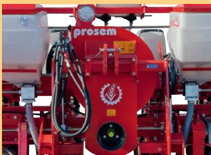
Turbina de gran capacidad y vacuómetro. Turbina meccanica di gran capacità con vacuometro.
