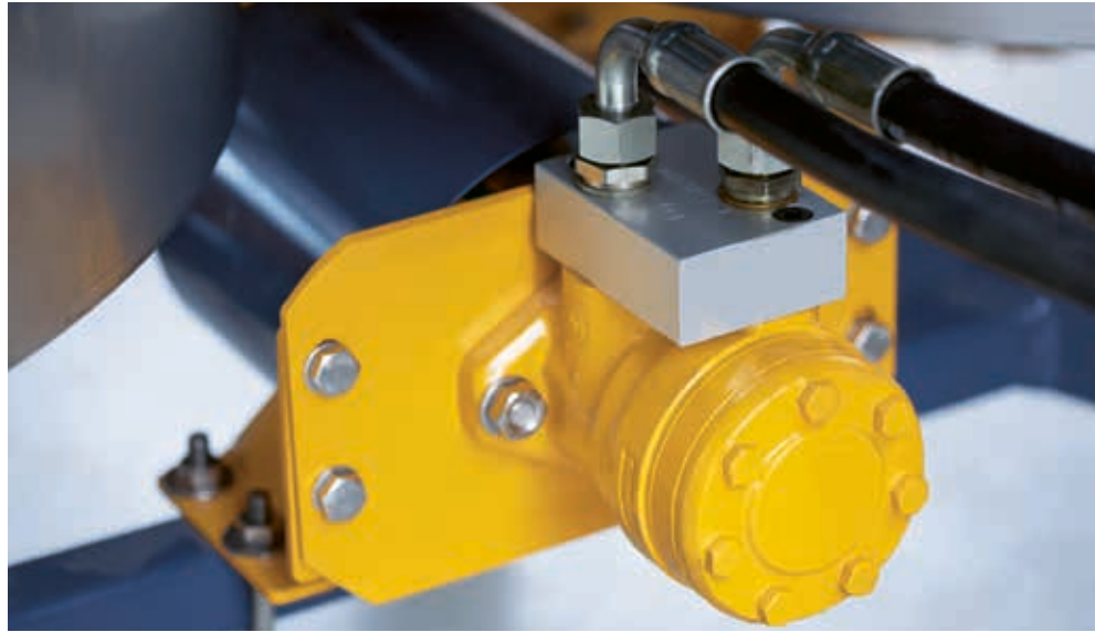
El sistema de accionamiento hidráulico es una solución económica y ahorra combustible.
