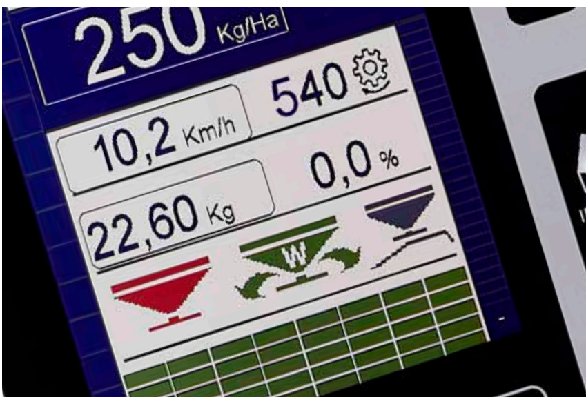
Las abonadoras equipadas con técnica de pesaje se calibran automáticamente en movimiento, por lo que no es necesario realizar una prueba de flujo manual.
