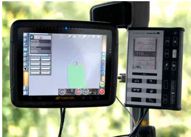
Terminal TopCon conectado a CALIBRATOR ZURF
