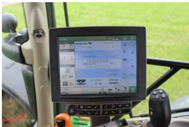
En las abonadoras con proporcionalidad al avance, las revoluciones de TDF se muestran directamente en la pantalla.
