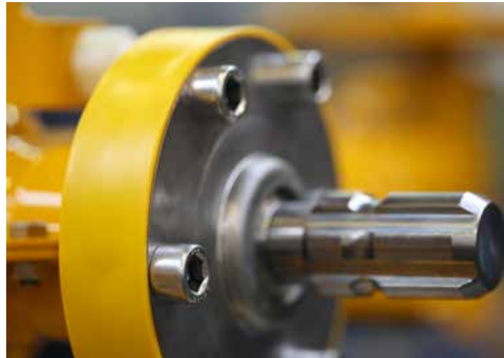
El embrague de sobrecarga integrado, resistente al agua y libre de mantenimiento, protege contra daños en el tractor, al eje de la TDF y la transmisión en caso de arranque a altas revoluciones del tractor.
