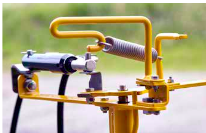
Control remoto hidráulico del abonado en cabeceras.
