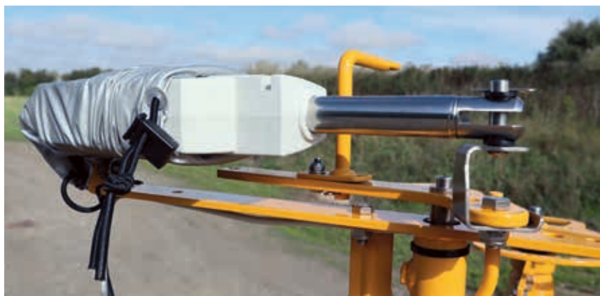
Mando a distancia eléctrico de abonado en cabeceras para CALIBRADOR TOTZ / ICON
