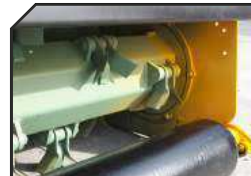
Obturaciones antialambres en rotor
