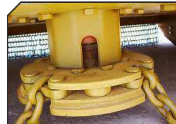
Rotor Serrat con cadenas intercambiables
