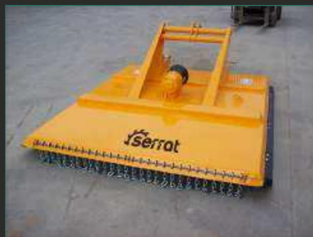
Desbrozadora de cadenas para trabajos forestales, mantenimientos agrícolas y jardinería, para tractores de 50 - 80 CV. Torreta solidaria al chasis. Refuerzos superiores. Plato SERRAT con sistema de anclaje de cadenas con bulones y diferentes bridas para cambiar el diámetro de la cadena.
