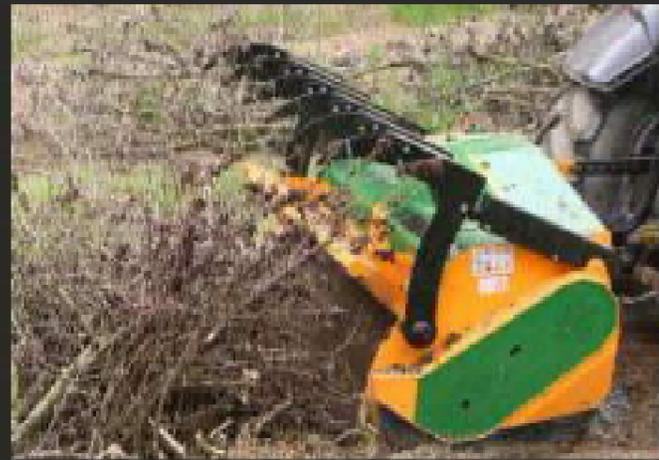
Trituradora forestal adaptable a todo tipo de tractores entre 180 - 280 CV. Equipada con martillos escamoteables, para ramas de cortas, desbroces forestales, fajas auxiliares, monte en pie, etc. Equipada con rotor de diente fijo con sistema FIXE TOP, para madera gruesa y tocones. Esta máquina incorpora todas las opciones posibles de serie necesarias para realizar un óptimo trabajo forestal.
