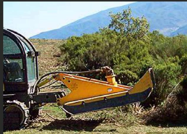
Desbrozadora forestal de cadenas con chasis monocasco en espesor de 15 mm. Grupo hasta 160 CV. Apta para desbroces forestales, creación de pastizales, monte bajo y líneas eléctricas, con matorral en pie hasta 80 mm. Torreta solidaria al chasis. Refuerzos superiores y placas antidesgaste inferiores, para evitar el choque de las cadenas contra el chasis en 15 mm. Plato con sistema de anclaje de cadenas con bulones.
