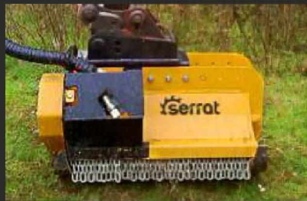
Cabezal adaptable a brazos forestales y excavadoras entre 6 - 15 TM. Chasis en chapa antidesgaste de 8 mm con el enganche atornillado en la parte superior, sobre largueros, que refuerzan el chasis, dando la posibilidad de varias posiciones de uso. Apta para desbroces forestales, cañas, matorrales, hasta 80 mm.
