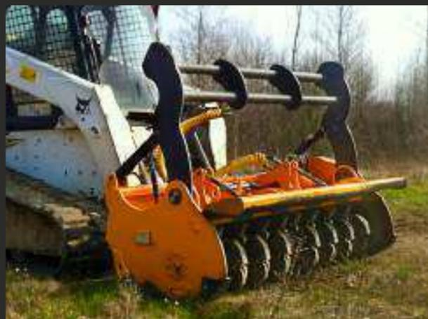
Trituradora para acoplar a minicargadoras de entre 3 y 9 TM. de ruedas o cadenas, utilizándose en trabajos de desbroce y mantenimientos forestales, jardinería industrial, ecc., combinando la maniobrabilidad de una cargadora rígida y las prestaciones de una trituradora.
