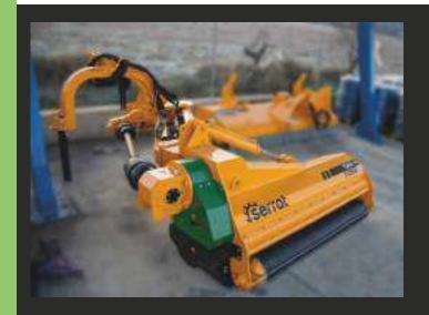
Desbrozadora de alta gama con rotor agrícola, multiuso polivalente, lateral y posterior, para trabajos en márgenes agrícolas, taludes, autovías, canales, carreteras y demás desbroce de obras públicas para tractores de 120 - 180 CV.
