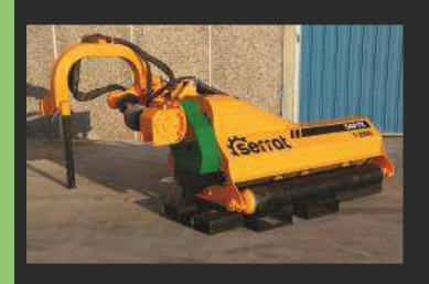
Desbrozadora de alta gama con rotor forestal, multiuso polivalente, lateral y posterior, para trabajos en márgenes agrícolas, taludes, autovías, canales, carreteras y demás desbroce de obras públicas y pistas forestales para tractores de 140 - 200 CV.
